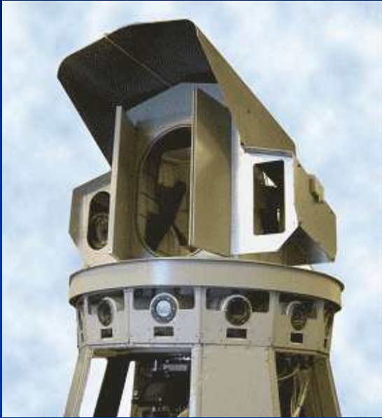
Лидар кругового обзора (комплекс «АСД-Лидар» НИИ прецизионного приборостроения, Москва)
