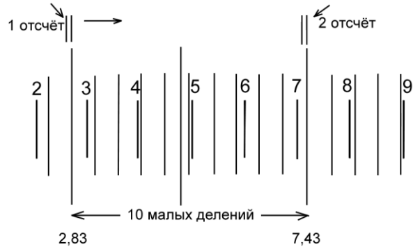
Рис. 3. Совмещение шкал объект-микрометра и окуляр-микрометра для вычисления цены малого деления окуляр-микрометра (второй способ)
